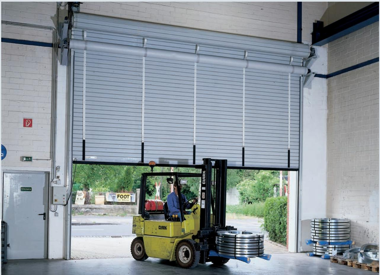
Schallschutz-Rolltor 31 dB mit Stützwelle
